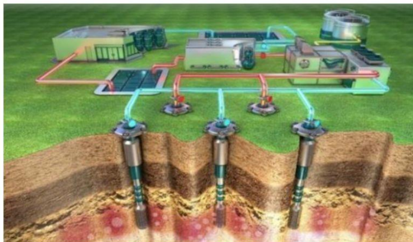
1-сурет. Уранды жерасты ұңғымалық шаймалау схемасы
